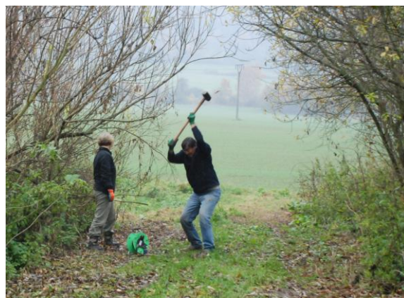
Obr. 4 Buzení energie úderem kladiva na destičku
