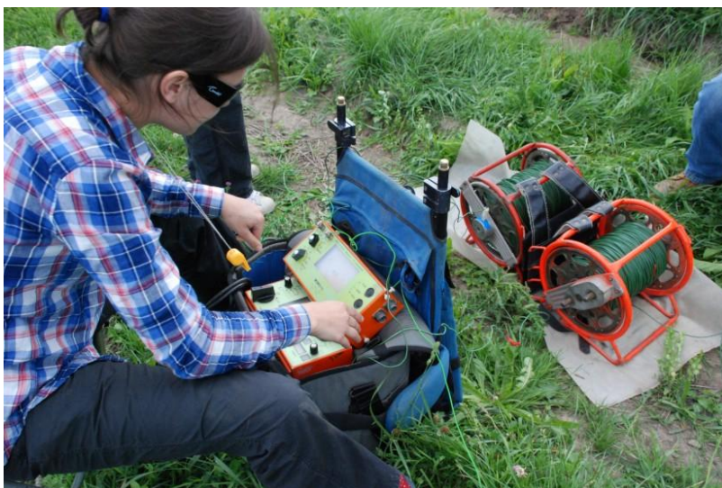
Obr. 1. Odporové měření s aparaturami MIMI a GEVY1000
